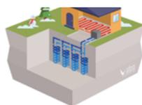
Mutualisation d'un ou plusieurs captages géothermiques pour desservir plusieurs bâtiments via un réseau de distribution (boucle). Chaque bâtiment est équipé d'une PAC pour chauffer/rafraîchir son réseau interne.
