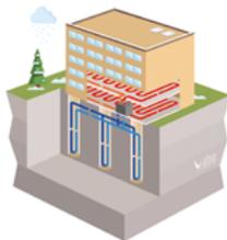
Prélèvement de la chaleur du sol à l'aide d'échangeur mis en place dans le sol (de type sonde, échangeurs compacts horizontaux - circuit fermé sans prélèvement dans le sol) et valorisation à l'aide de la PAC.
