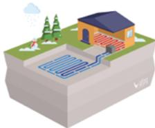
Récupération de l'énergie contenue dans les nappes d'eau souterraines via un échangeur et une PAC puis réinjection de l'eau prélevée dans son milieu naturel pour pérenniser la ressource.
