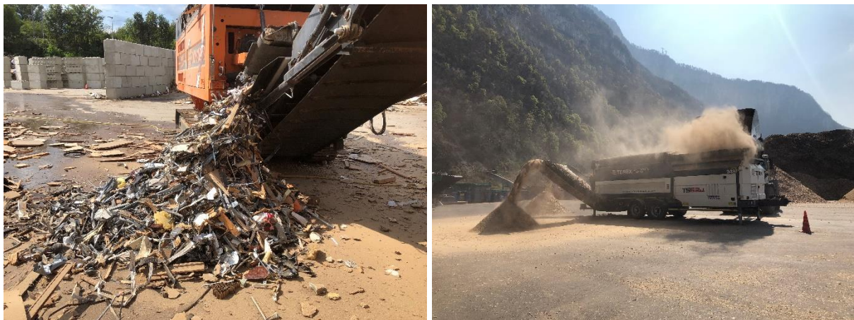
Figure 11. Déferrailage en sortie de broyage de déchets de bois B (à gauche) et étape de criblage (à droite) - Source Biomasse Normandie
