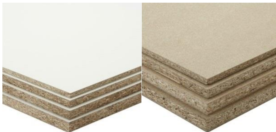
Figure 12. Panneaux de particules avec une surface mélaminée (gauche), et sans surface mélaminée (droite)
