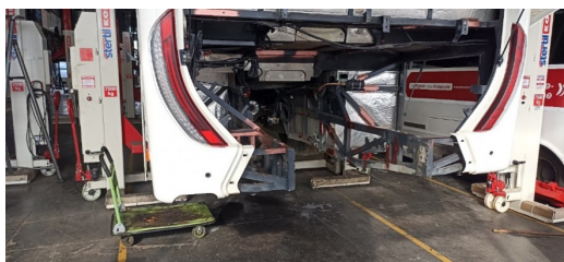
Chantier de transformation (dépose du moteur thermique)
