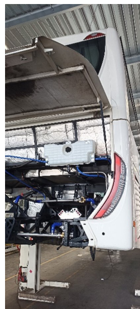
Repose du moteur électrique avant pose des packs batterie (arrière du véhicule)
